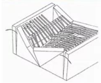
Figura 1-257: Flessione orizzontale con cerniere verticali: generalità e sua evoluzione nel movimento
