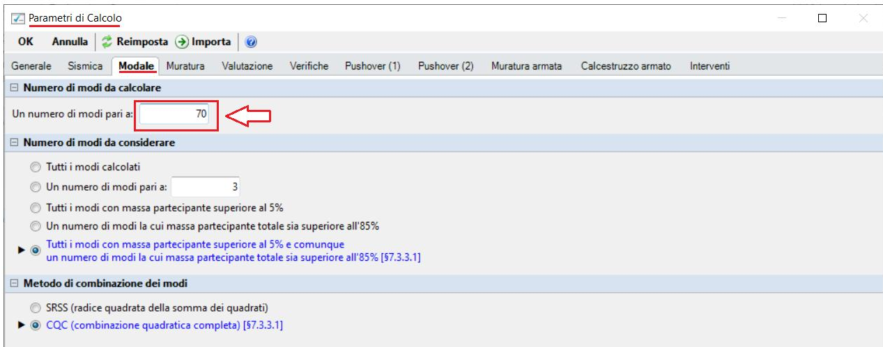
Figura 1-317: Parametri di calcolo: Scheda "Modale"
