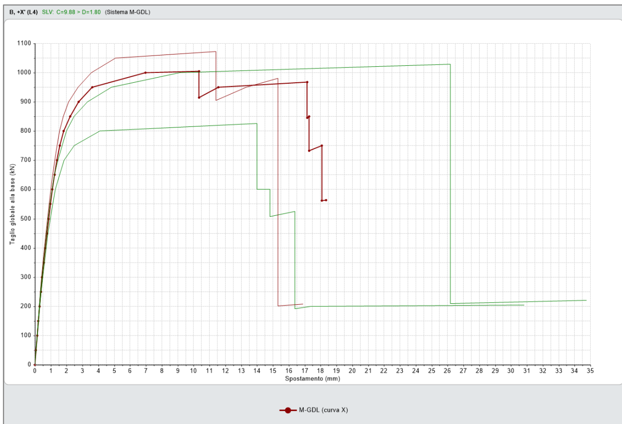
Figura 1-169: Analisi Pushover: Fascio di curve calcolate, in direzione +/-X e +/-Y
