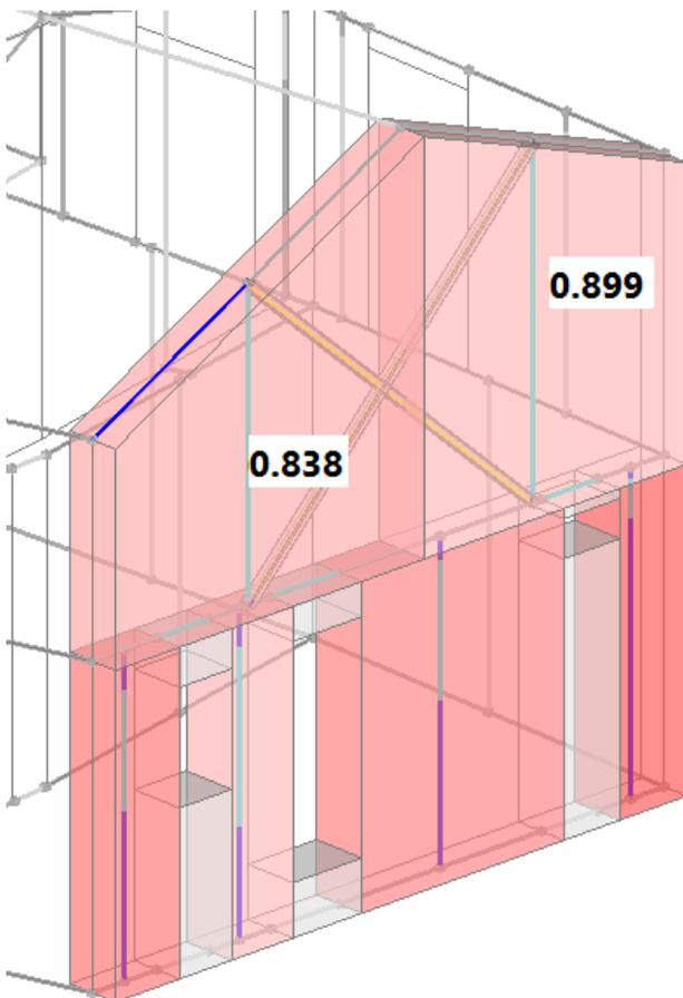
Le aste di controvento possono reagire solo a trazione (possono sostenere anche sforzi di compressione, purché inferiori al carico di punta). L'esatta valutazione del carico di punta richiede ulteriori dati non disponibili al momento in PCM: pertanto, le bielle di controvento vengono per semplicità considerate reagenti a compressione nei confronti degli sforzi normali di origine statica. All'inizio dell'analisi pushover,
