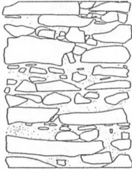
Data la natura della muratura risulta quindi molto improbabile che si inneschino meccanismi di rottura per taglio scorrimento, mentre sembrano più plausibili rotture per taglio con fessurazione diagonale. Per questo motivo si è scelto di non far eseguire al programma le verifiche per taglio scorrimento sugli elementi in muratura di pietrame. Questo è anche un utile esempio per focalizzare l'utilizzo dei comandi di selezione e di creazione di gruppi presenti in PCM.
