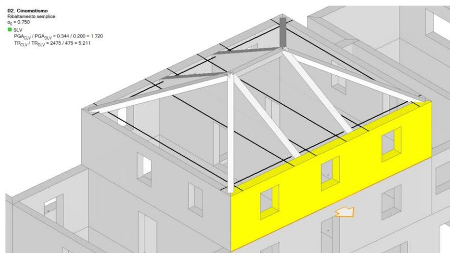
A questo punto selezionando una catena potremo inserire i parametri geometrici, quali diametro, dimensione delle piastre etc. così come mostrato in figura.
