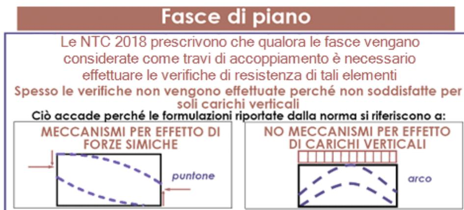
Figura 122. Modellazione delle fasce di piano
