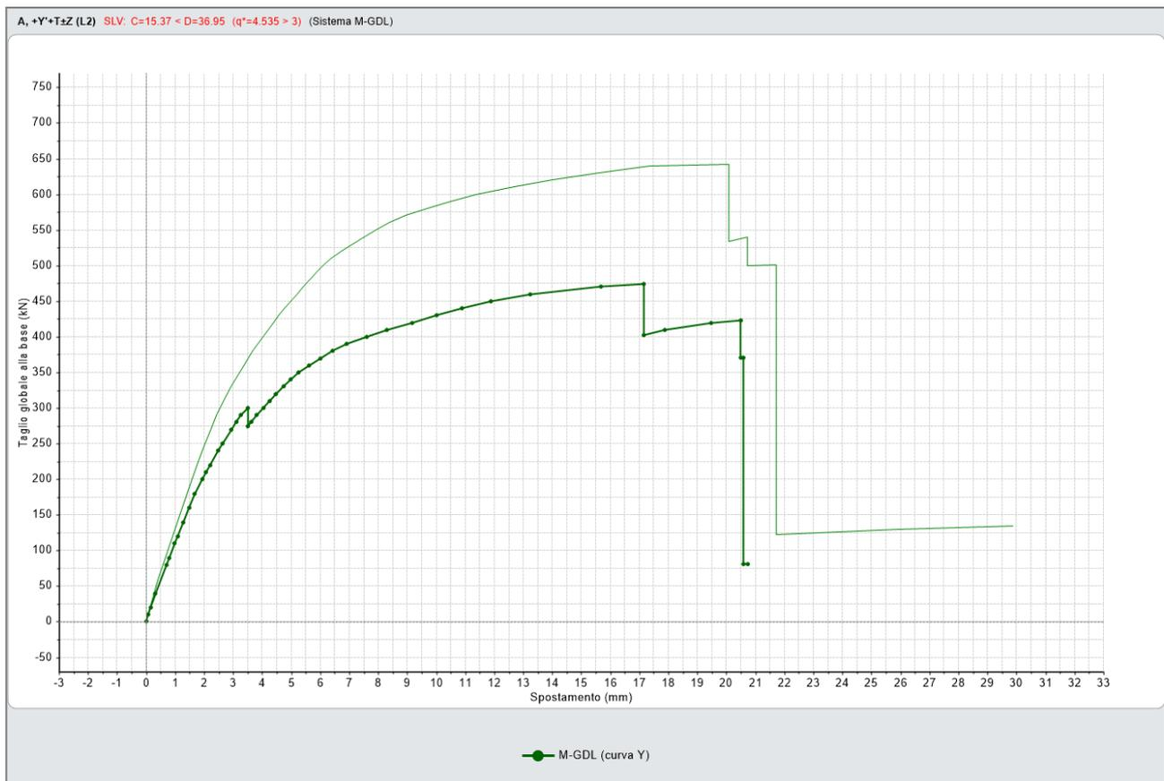
Figura 153. Curva Pushover: con componente sismica verticale (linea spessa) e senza (linea sottile)
