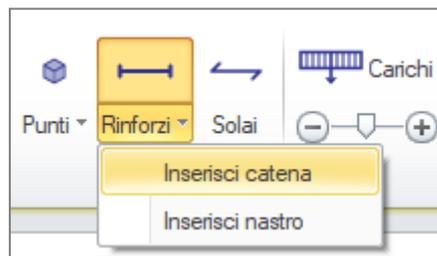
Il pulsante [Elementi > Rinforzi] costituisce anche il controllo per attivare o disattivare la visualizzazione di catene e nastri nella finestra grafica.
