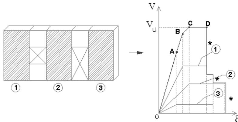
**Fig. 1.4.1.** Global force-displacement diagram
