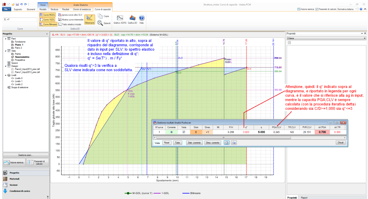
Fig. 5.2.5.2. q^* per la verifica di sicurezza per SLV e per il calcolo dell'Indicatore di Rischio Sismico
