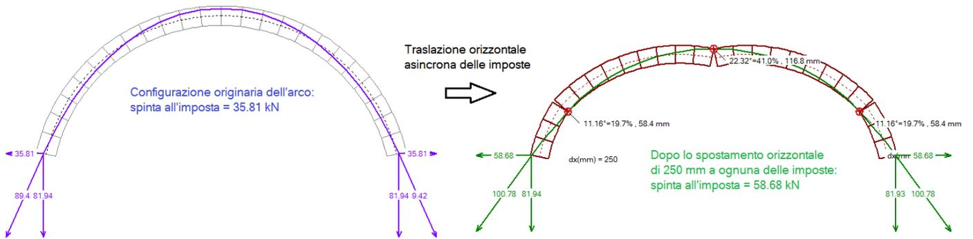
Nel grafico seguente, si riporta l'andamento della spinta alle imposte in funzione dello spostamento orizzontale verso l'esterno. Via via che lo spostamento aumenta, la spinta aumenta con legge di tipo parabolico.
