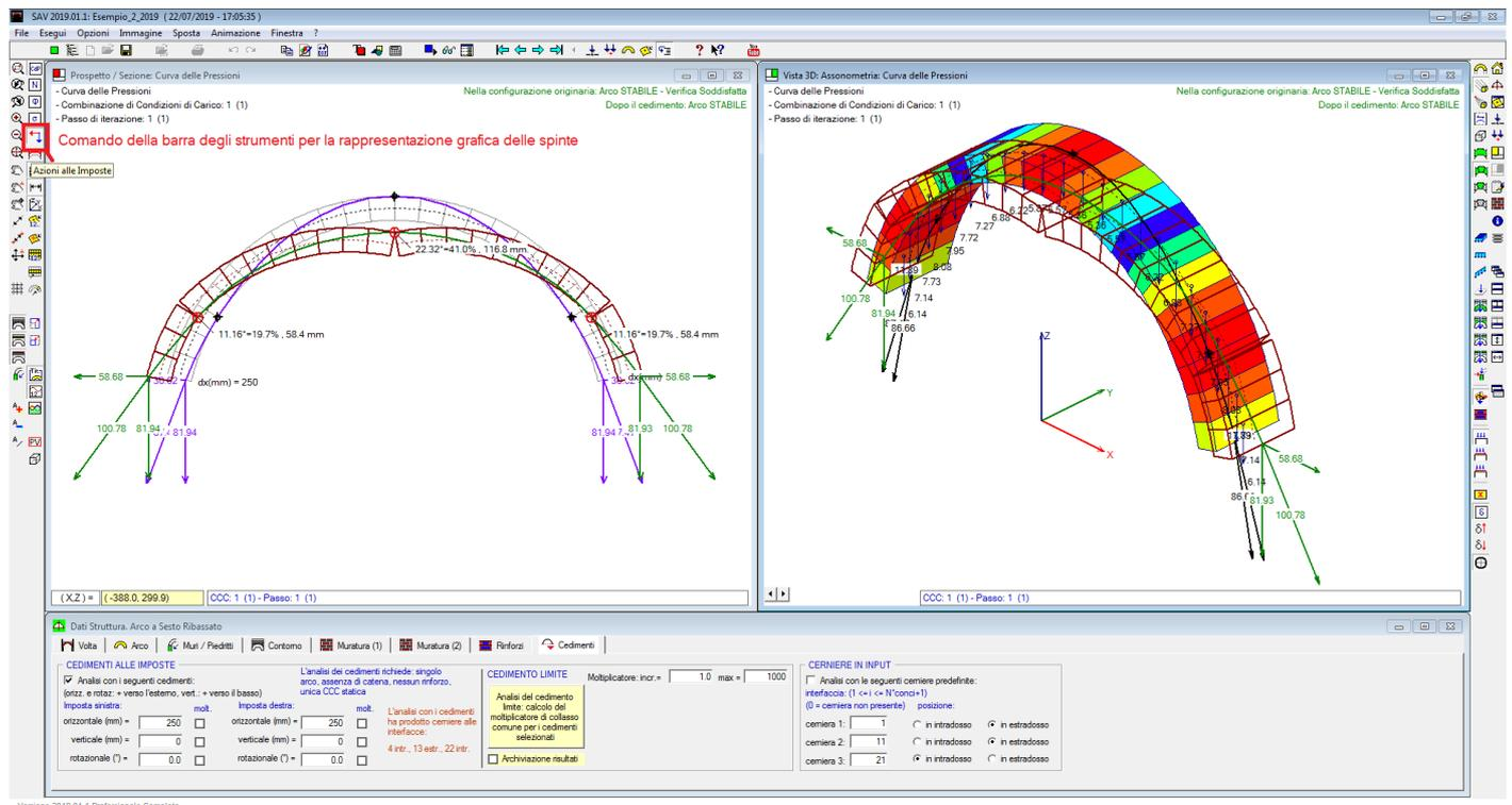
L'immagine seguente pone a confronto l'assetto statico originario dell'arco con quello dopo la deformazione dovuta allo spostamento orizzontale delle imposte.
