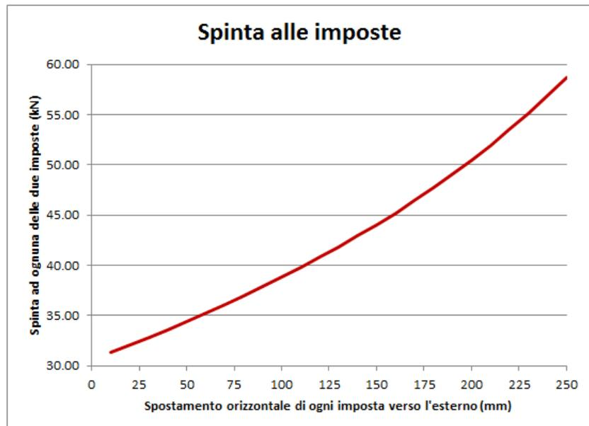
Da notare che il valore della spinta statica in quiete: 35.81 kN, si riduce immediatamente a 31.34 kN non appena interviene un piccolo spostamento orizzontale (pari a 1 cm.) che generando tre cerniere riposiziona la curva delle pressioni, per poi riaumentare con il progredire della deformazione.
