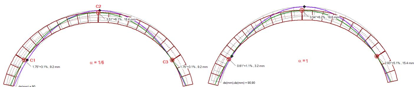
Nella tabella seguente si riportano, per ogni valore del cedimento verticale rispetto all'orizzontale (fisso a 90 mm.) la dimensione della fessura in corrispondenza delle tre cerniere e l'incremento percentuale della fessurazione rispetto alla configurazione senza cedimento verticale.
