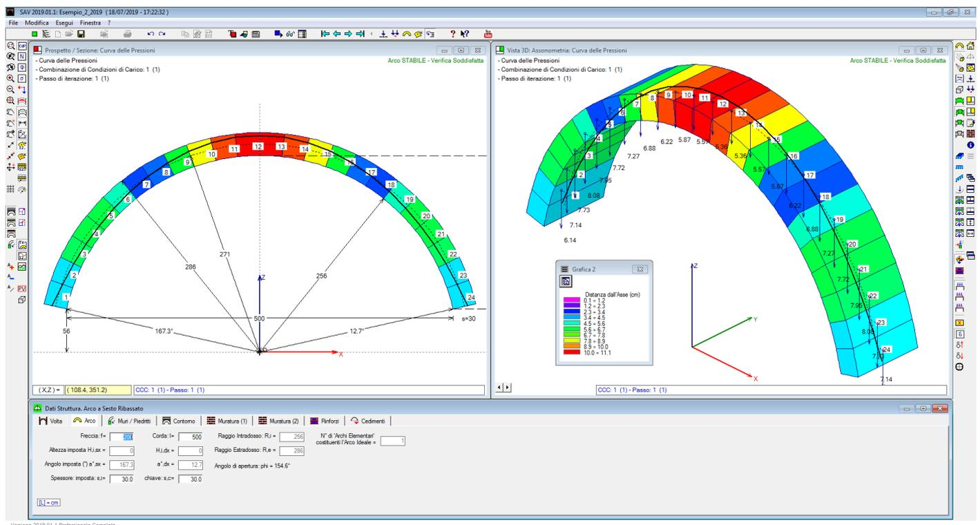
L'immagine evidenzia una curva delle pressioni totalmente inclusa nell'arco, senza formazione di alcuna cerniera statica. L'analisi degli effetti di cedimenti potrà quindi procedere individuando la tripletta di cerniere generate dal cedimento, in grado di soddisfare sia le condizioni cinematiche (sulla compenetrazione del materiale) sia quelle statiche (sull'equilibrio con curva delle pressioni interna alla sagoma dell'arco).
