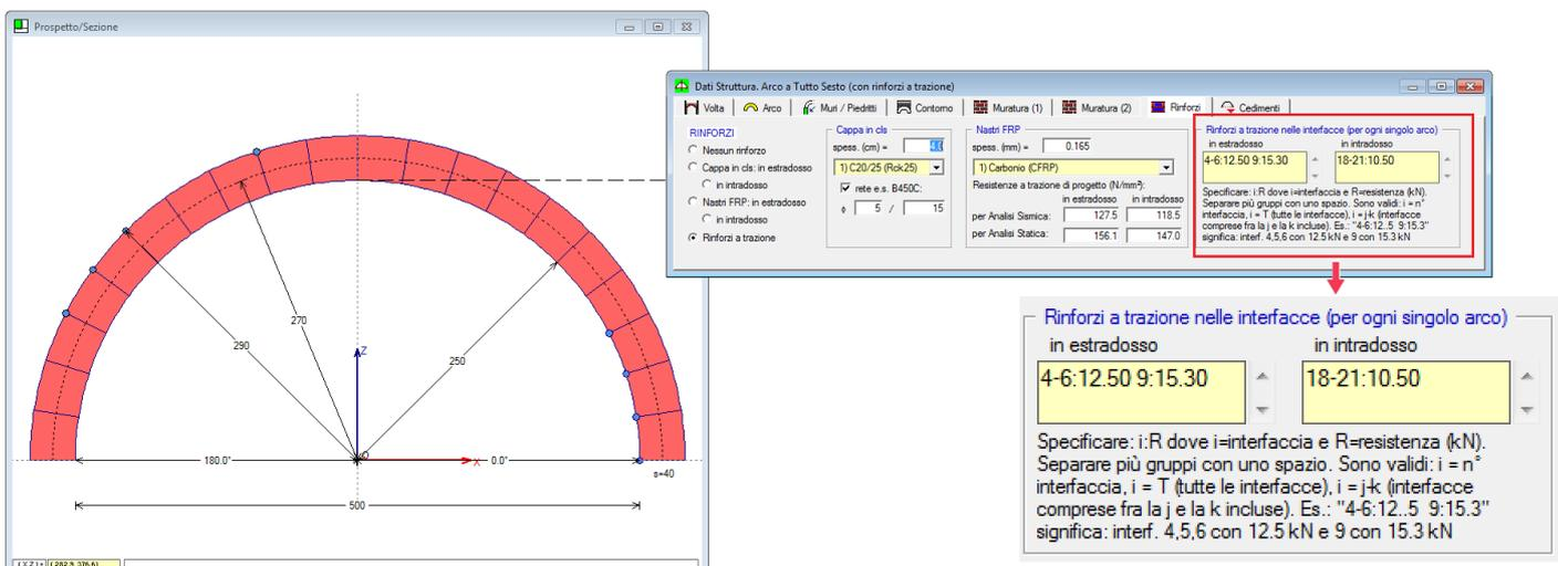
Per quanto riguarda l'arco rinforzato, è opportuno ricordare la distinzione dei casi di rinforzi di superficie (cappa in cls armato o nastri in FRP) da quelli di rinforzi localizzati (catene, o rinforzi a trazione in specifiche interfacce).
