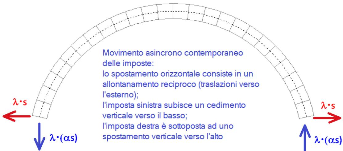
Nel processo di analisi incrementale per la ricerca dello spostamento orizzontale limite delle imposte, tutti gli spostamenti sono sottoposti al moltiplicatore comune  $\lambda$ .
