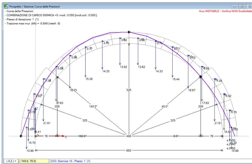
Anche per un piccolo valore del moltiplicatore orizzontale, pari a 0.050, la curva delle pressioni, a causa delle cerniere imposte dal cedimento, fuoriesce nelle zone di estradosso a sinistra della chiave. Il moltiplicatore di collasso risulta nullo. Questo risultato ci mostra che un cedimento verticale ad un'imposta può condizionare fortemente il successivo comportamento sismico dell'arco.
