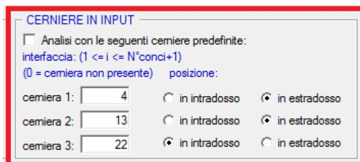
Per eseguire l'**analisi con cerniere predefinite**, nel riquadro 'CERNIERE IN INPUT' si deve selezionare il check 'Analisi con le seguenti cerniere predefinite'. Il valore 0 indica un campo da non considerare.
