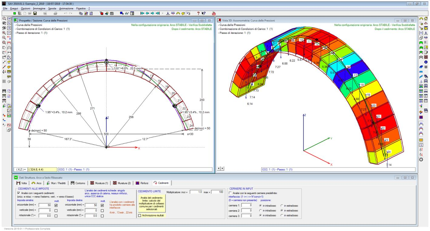
In assenza di spostamenti delle imposte, la curva delle pressioni si discosta al massimo 11.1 cm. dall'asse dell'arco; in presenza di spostamenti, lo scostamento, in corrispondenza delle interfacce sedi di cerniera, sale a 15.0 cm.
