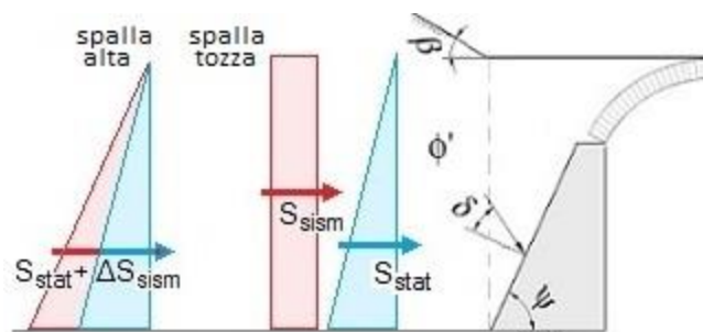
Fig. 1.11. Spinte del terreno nei casi di spalla alta e di spalla tozza
