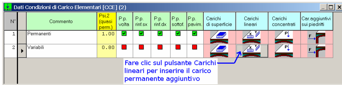
Fig. 2.2.15. Condizioni di Carico Elementari
