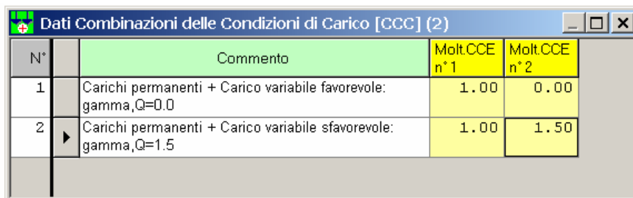
Fig. 2.2.17. Definizione delle combinazioni di condizioni di carico
