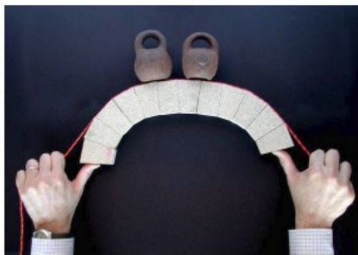
Schematizzazione del funzionamento dell'“arco armato”. I conci risultano tanto compressi quanto tesa è la fune
