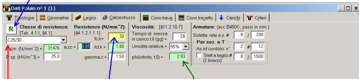
Il calcestruzzo è stato definito di classe di resistenza C25/30: normalmente, il corrispondente valore di  $f_{ck}$  è pari a 25 N/mm<sup>2</sup>
