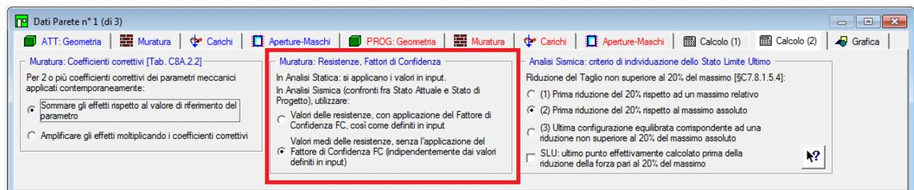
Limitatamente alle verifiche sismiche è così possibile, per ogni maschio murario, considerare i 'valori medi' delle resistenze di riferimento indipendentemente dai valori corrispondenti al materiale murario scelto per i singoli maschi murari, ed evitare l'applicazione di FC definito in input (ossia: adottando FC=1.00).
