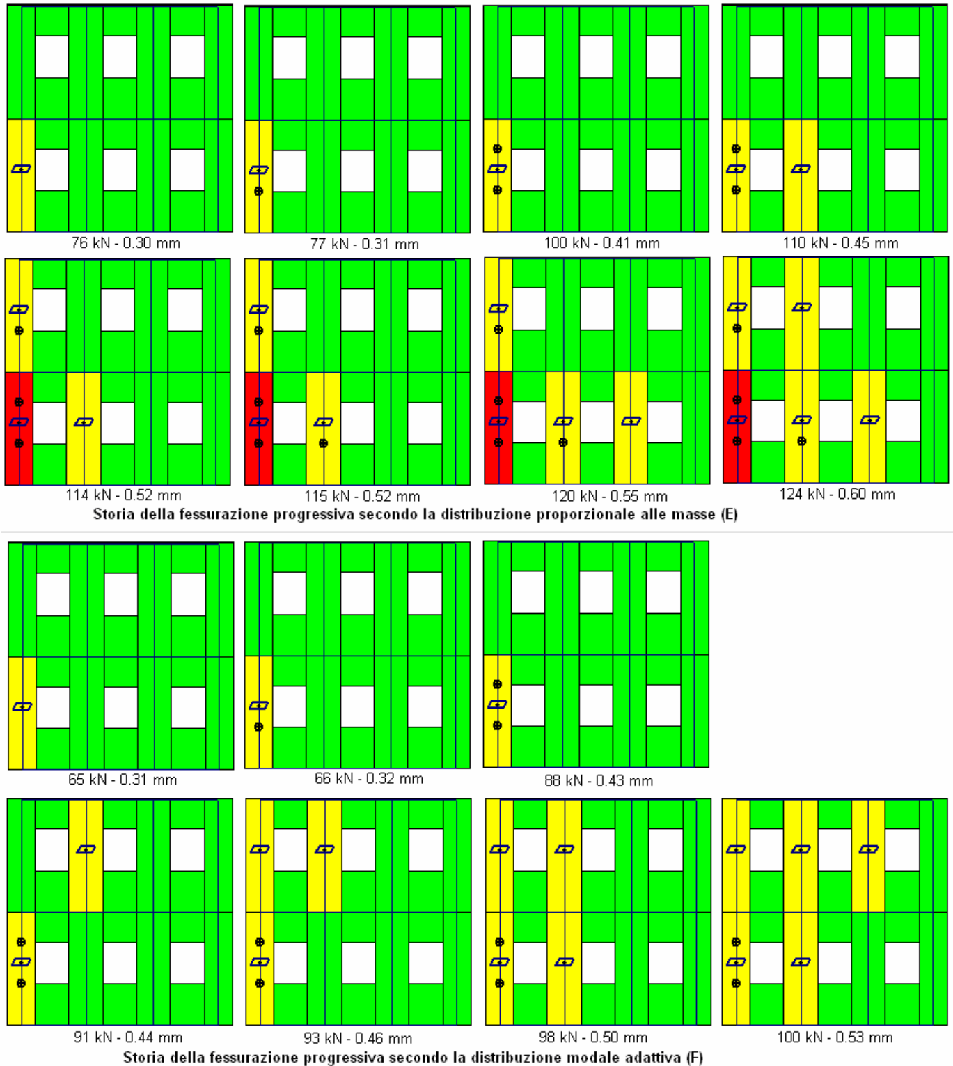
Fig. 4.1.25. Storia della fessurazione progressiva
