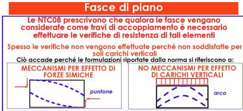
Fig. 2.7. Dal documento di riferimento: comportamento delle fasce sotto forze sismiche e per carichi verticali
