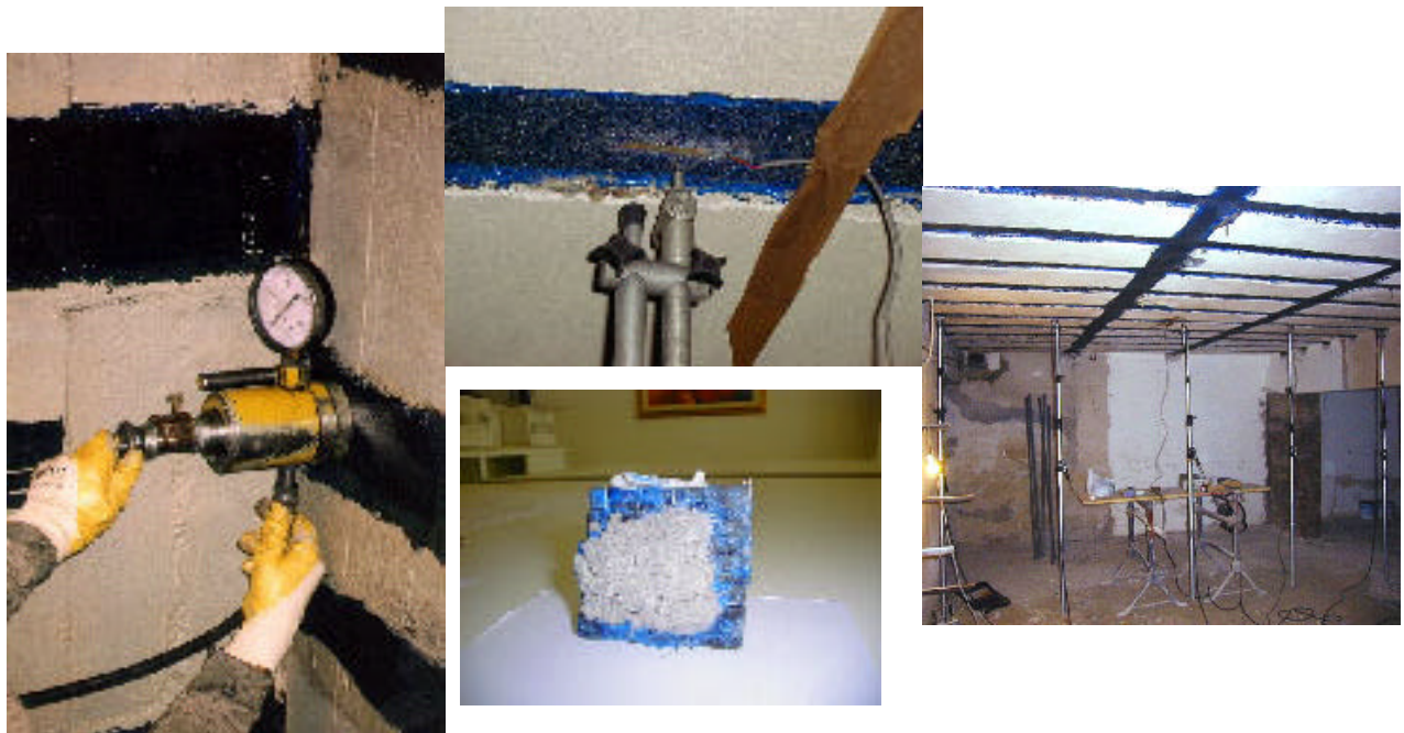
Fig.- 24 –25 – 26 – Prove di adesione, prove di carico, strumentazione delle fibre.
