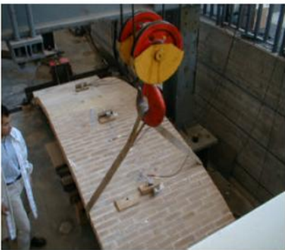
Modalità di imposizione della deformata iniziale sulla volta integra ad un quarto della luce: innalzamento della volta per consentire le vibrazioni libere [1] [2]
