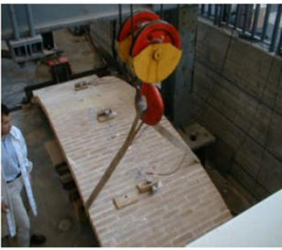
Modalità di imposizione della deformata iniziale sulla volta integra ad un quarto della luce: innalzamento della volta per consentire le vibrazioni libere [1] [2]
