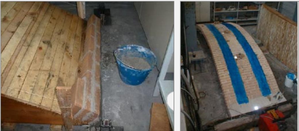
Test sperimentale: applicazione di nastri di rinforzo*
