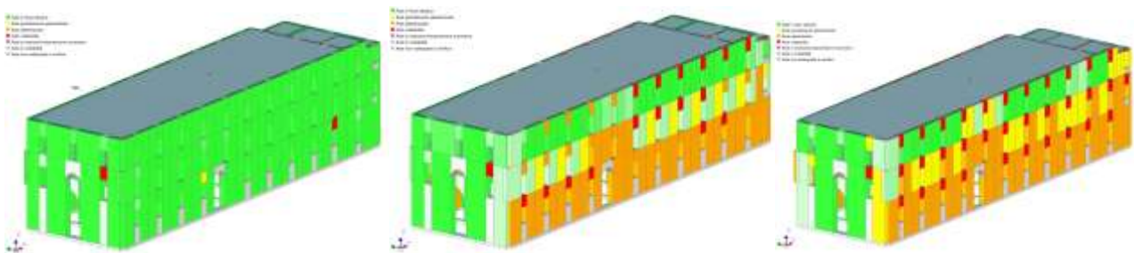
Figura 15 – Curva di capacità E+X. Da sinistra: al primo passo dell'analisi, per spostamento del punto di controllo pari a 11.13 mm e alla capacità ultima della struttura
