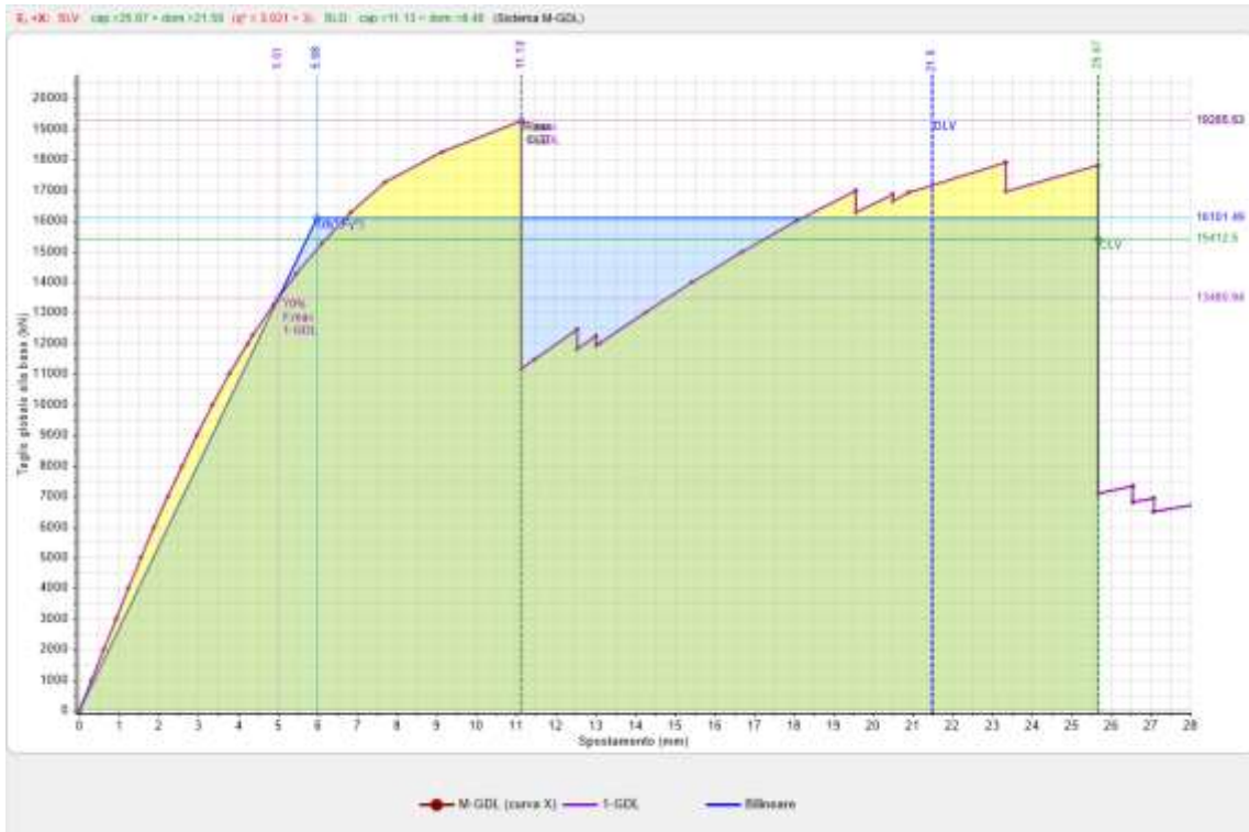
Figura 12 – Curva di capacità in direzione X positiva, ottenuta con distribuzione di forze E.
