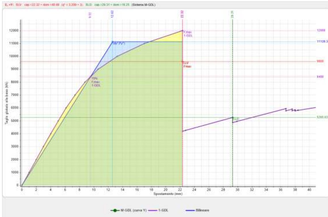
Figura 14 – Curva di capacità in direzione Y positiva, ottenuta con distribuzione di forze E.
