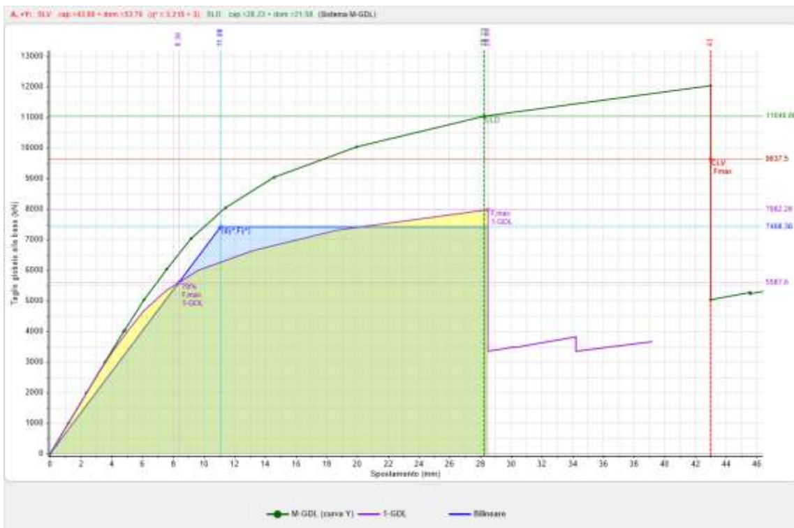
Figura 13 – Curva di capacità in direzione Y positiva, ottenuta con distribuzione di forze A.
