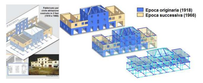
La procedura dell'analisi per fasi costruttive viene applicata a due strutture distinte: la "struttura originaria" (A) e la "struttura successiva" (B).
