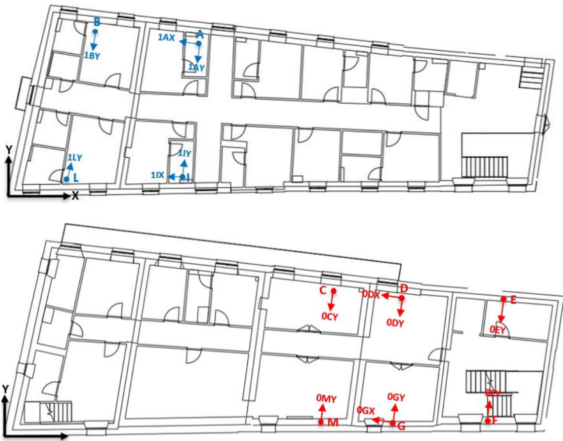
Figura 71: posizione accelerometri 2° prova
