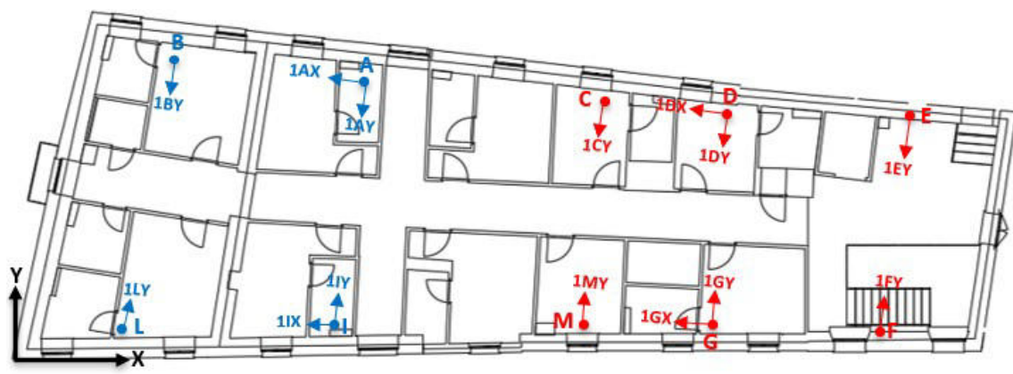
Figura 69: posizione accelerometri 1° prova
