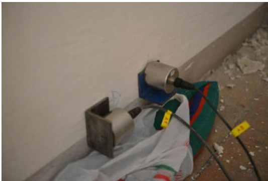
Figura 46. Accelerometri disposti in direzione x e y
