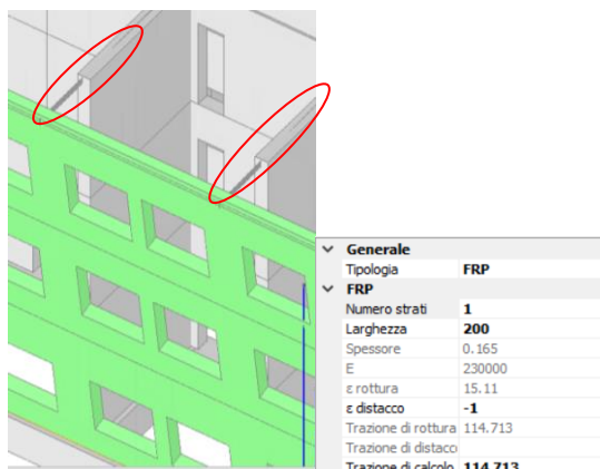
Figura 188. Rinforzo del cinematismo di ribaltamento dello spigolo con nastri FRP incollati alla muratura.
