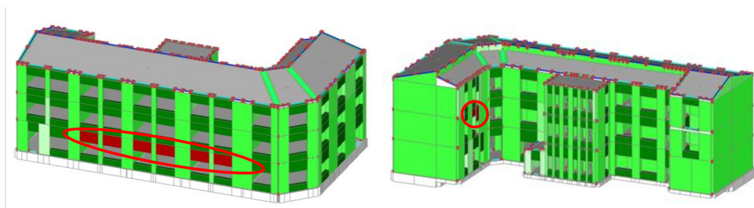
Figura 142. Strisce non verificate in Analisi Pushover.
