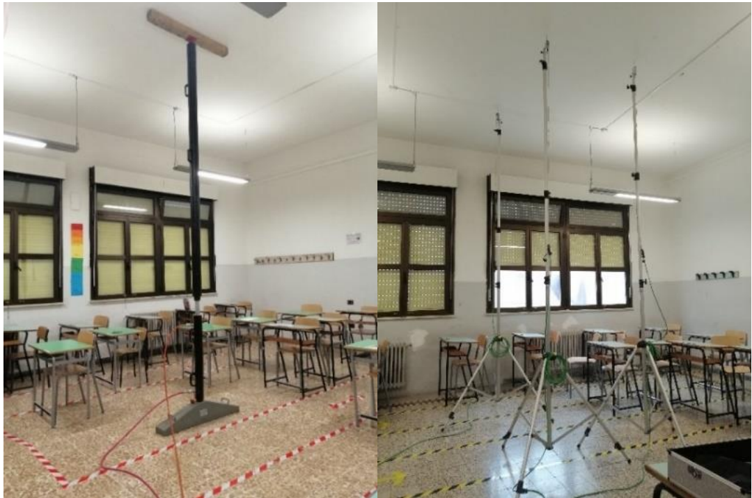
Figura 37. Prove di carico su solaio con martinetto idraulico e comparatori.
