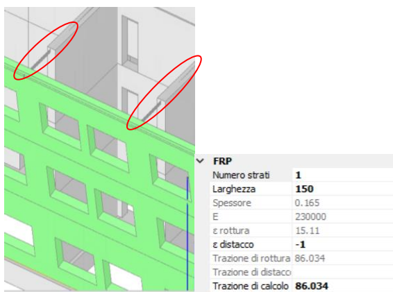
Figura 188. Rinforzo del cinematismo di ribaltamento dello spigolo con nastri FRP incollati alla muratura.
