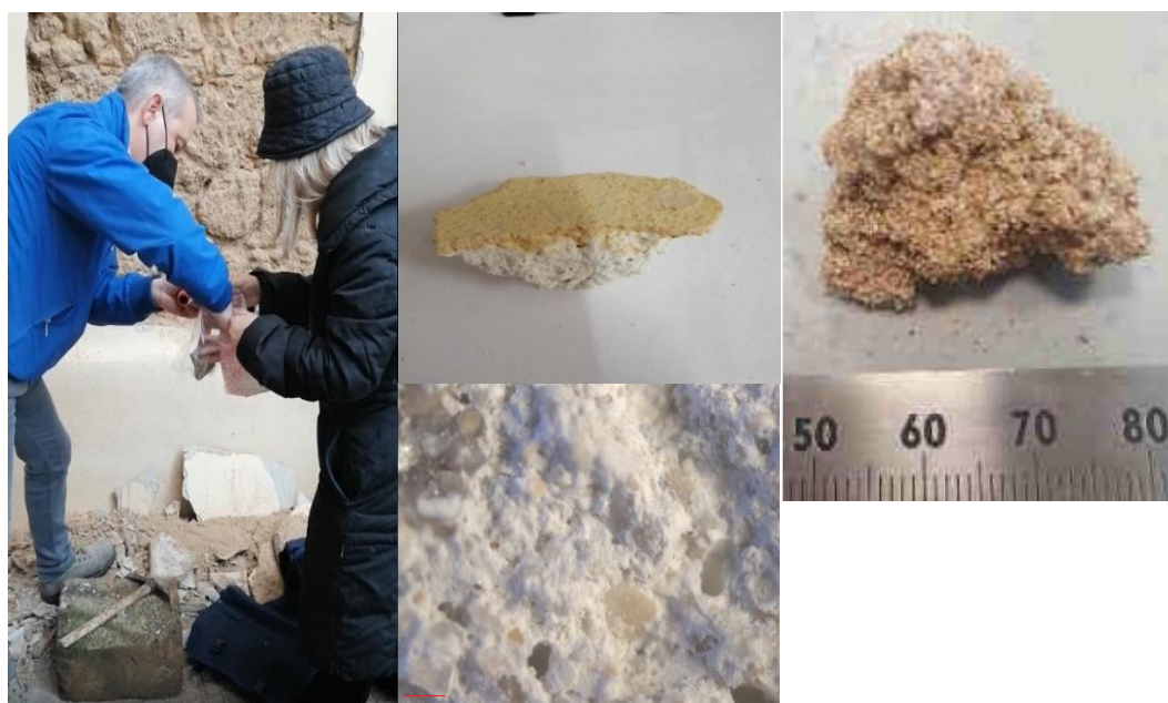
Figura 33. (a) Campione di intonaco in malta di calce; (b) Campioni di materiale lapideo arenaria prelevati in situ.
