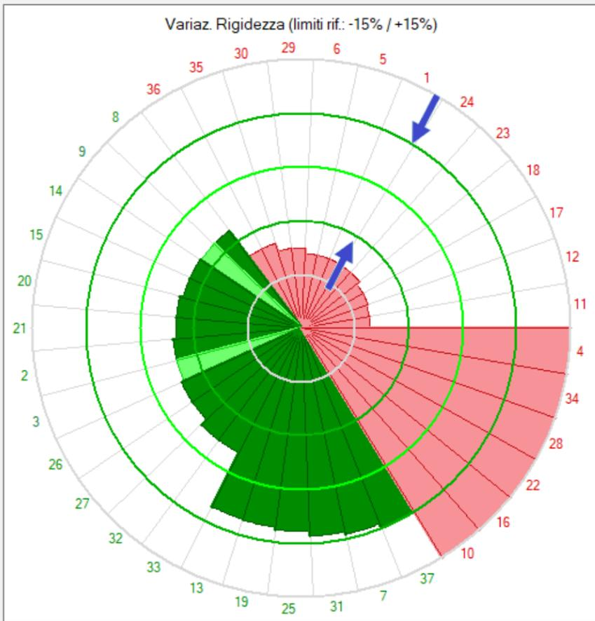
Scelto un insieme di parametri variabili di progetto, si generano N combinazioni, ciascuna analizzata dall'Analisi Parametrica: in un **grafico radar specializzato**, consistente in un istogramma circolare, gli spicchi corrispondenti alle singole combinazioni vengono colorati con riferimento a due cerchi interni che determinano la zona di verifica di sicurezza soddisfatta.
