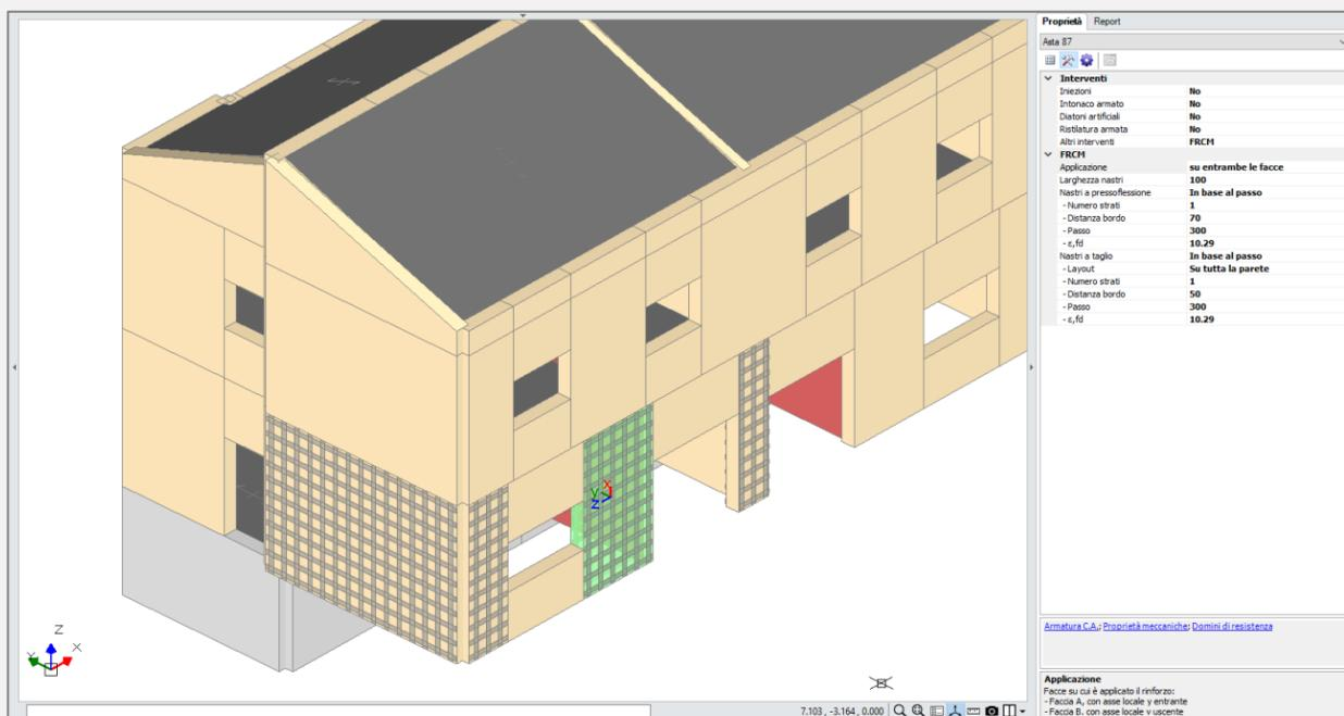
In **Aedes.PCM** per modellare un rinforzo con compositi FRCM si specificano le caratteristiche del composito nei Parametri di Calcolo e si definisce il layout del rinforzo nelle proprietà delle singole aste del modello strutturale.
