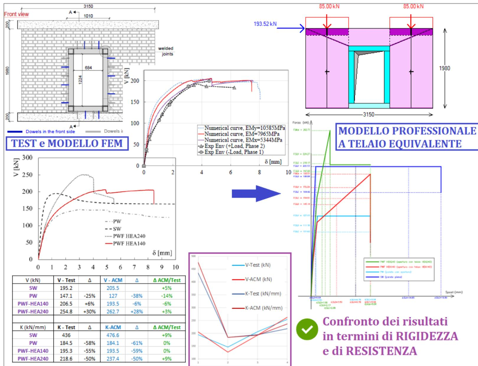
In campo professionale, l'analisi degli interventi sulle pareti in muratura, con creazione o spostamento di aperture e conseguenti realizzazioni di rinforzi con telai o altre tecnologie, può svolgersi in modo corretto ed efficace con il metodo del telaio equivalente, senza necessità di ricorrere a metodi FEM non lineari avanzati.
