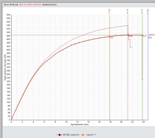
Nella curva con **metodo Incrementale** sono evidenti le curve secondarie (sottocurve) elaborate per poter registrare le cadute di taglio globale in corrispondenza dei collassi di alcuni elementi strutturali.
