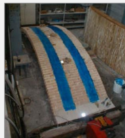
Test sperimentale: applicazione di nastri di rinforzo*
